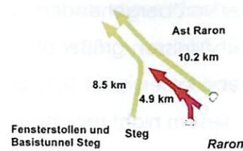
Abb. 14 Vergleichsvortriebe je 4,6 km zyklisch (rot) und kontinuierlich (gelb)
