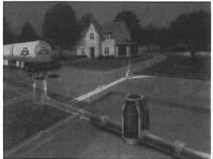
Abb. 42. Prinzipskizze Flutungsverfahrens (Quelle Sanipor)
