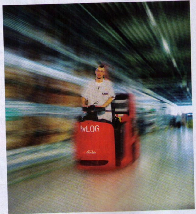
Mit einer Solar-Tankladung drei Tage Dauerbetrieb: Schlepper bei Fronius mit Brennstoffzellen
