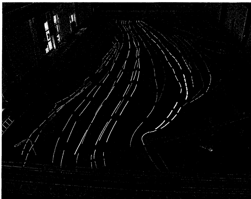
Abb. 13: UW-Ansicht, mit schwimmenden Leuchtkörpern visualisierte Stromlinien und Fließgeschwindigkeiten.
