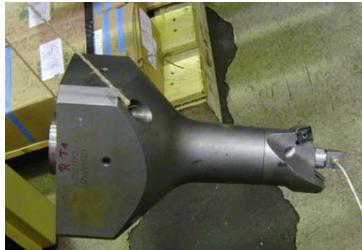
Abbildung 5: Eigenfrequenzbestimmung des kleinen Werkzeughalters
