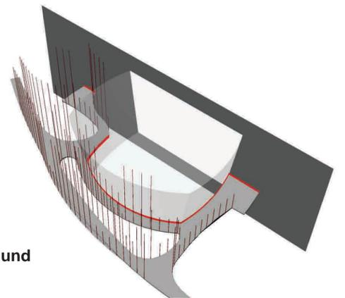
Prinzip: Aufhängung und Lastenlagerung der Foyerebenen 1 und 2
