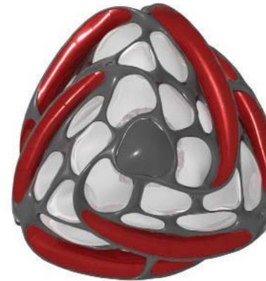
**Die Gleitflächen** dienen der Energiegewinnung. Pro Seite gibt es 3 Gleitflächen wovon nur die Mittlere der Energiegewinnung durch Wasserkraft dient. Die obere und untere dient rein der Sinkstabilität.
