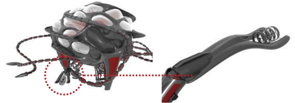
**Turbinen** zur Energiegewinnung wenn der Arm nicht zum Arbeiten genutzt wird
