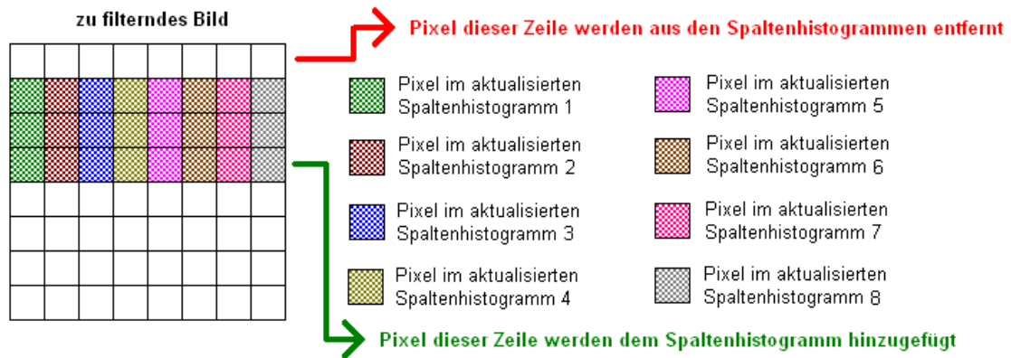
Abb. 34: Aktualisierung der Spaltenhistogramme in einem 8x8 Bild bei Wechsel auf die 3. Bildzeile, Radius des Median-Filters: 1
