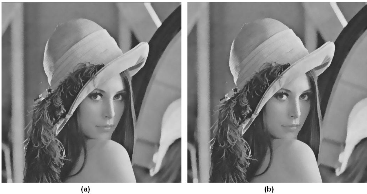
Abb. 14: (a) Ergebnis nach Anwendung des 11x11 Bilateral Filters (b) Ergebnis nach Anwendung des 11x11 Bilateral Median-Filters
