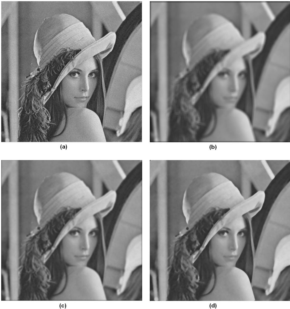
Abb. 12: (a) Verrauschtes Originalbild (b) Ergebnis nach Anwendung des 7x7 Mittelwertfilters (c) Ergebnis nach Anwendung des 11x11 Gauß-Filters, \sigma = 2.00 (d) Ergebnis nach Anwendung des 7x7 Median-Filters
