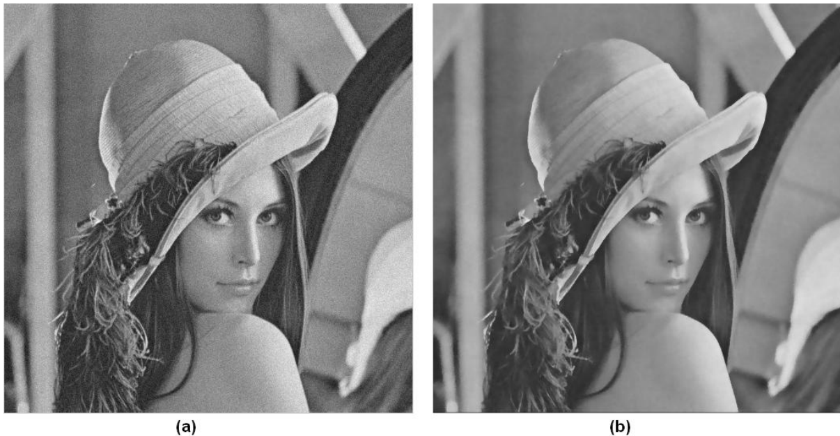
Abb. 13: (a) Verrauschtes Originalbild (b) Ergebnis nach Anwendung des 11x11 Bilateral Filters
