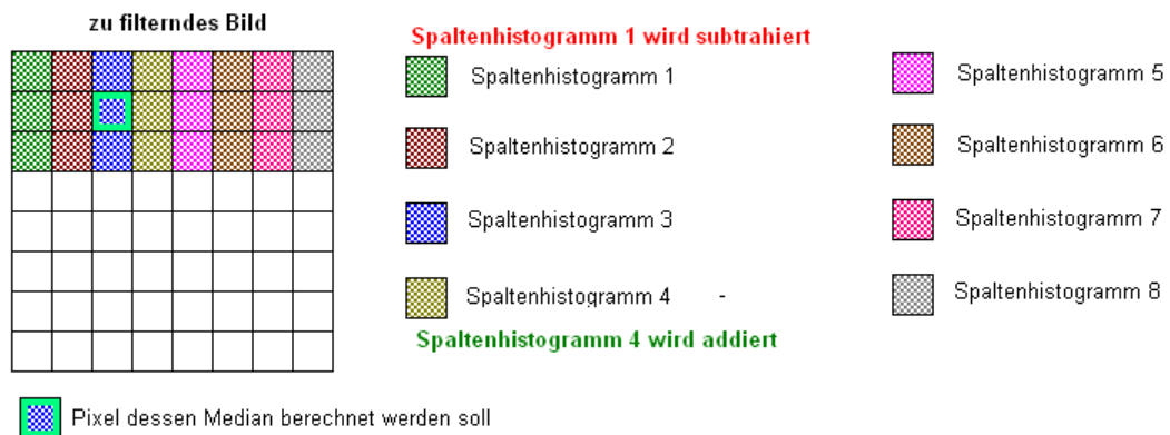
Abb. 33: Aktualisierung des Kernel-Histogramms in einem 8x8 Bild bei Wechsel zu umrandeten Position, Radius des Median-Filters: 1
