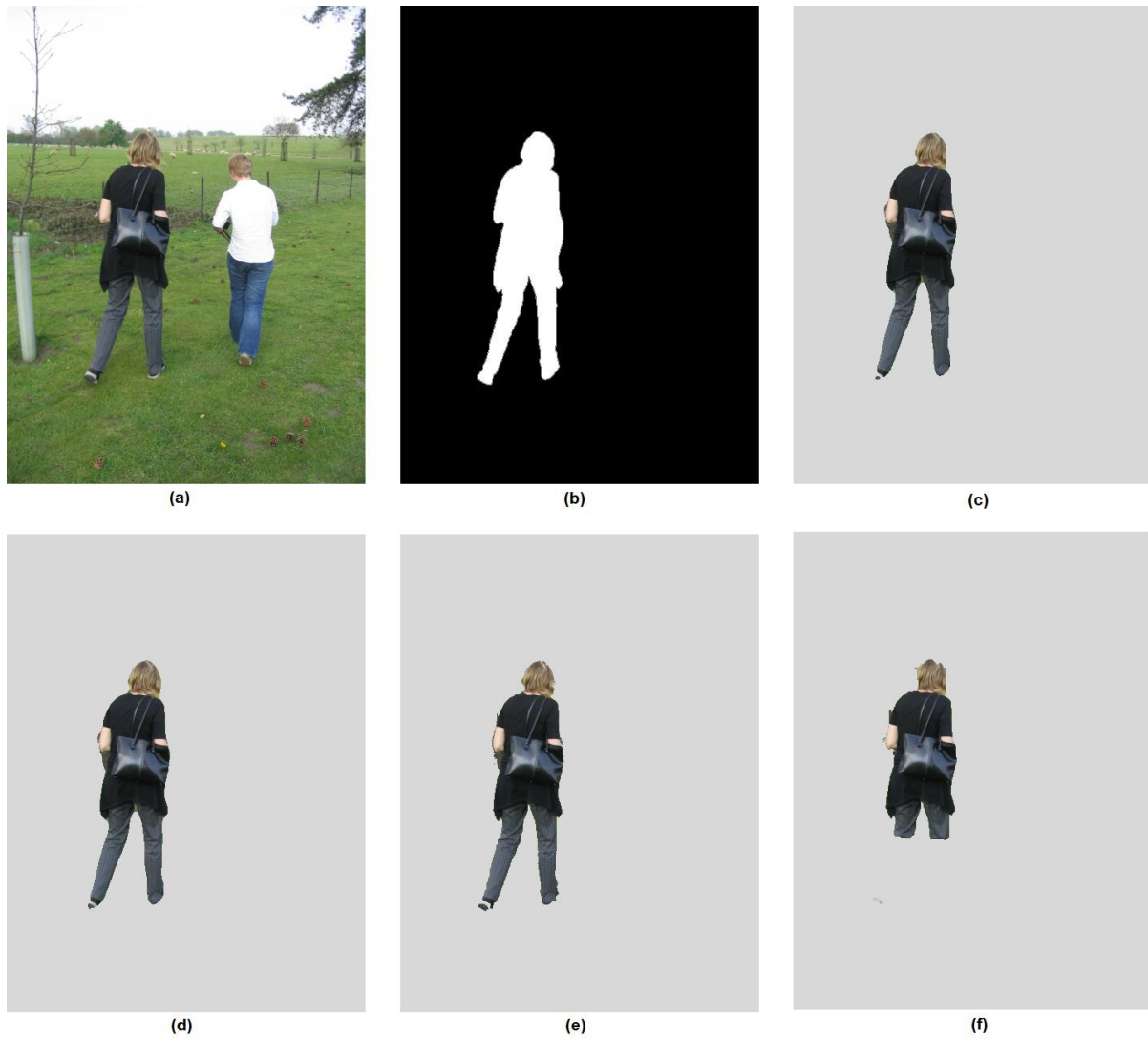
Abb. 61: Segmentierung von „person5“ (a) Zu segmentierendes Bild (b) Lasso-Trimap (c) Joint Bilateral Filter (d) Joint Bilateral Median Filter (e) Guided Image Filter (f) Grab-Cut
