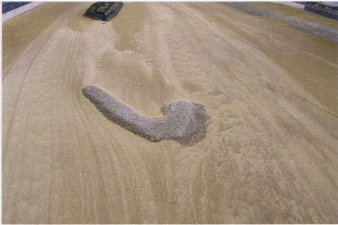
Abb. 5. Sohle im Bereich des Strömungsteilers nach einer rund 12-tägigen (Natur) Belastung (entsprechend HSW), Blick stromab
