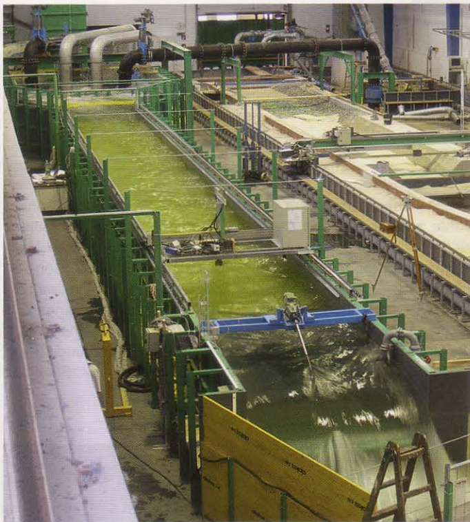
Abb. 2. Gesamtansicht des Schnittmodells, M 1:10, Blick Richtung Oberwasser
