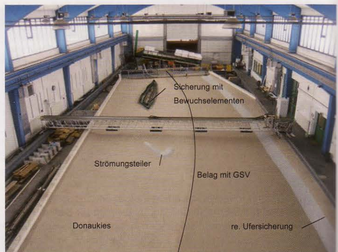
Abb. 4. Gesamtansicht des Flächenmodells im Maßstab 1: 33⅓, Blick stromab
