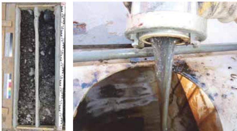
Abb. 3: Links: Kernkiste mit verunreinigtem sandigen Kies aus dem Versuchsfeld (vgl. Abb. 2) vor Durchführung der thermisch-hydraulischen Sanierung. Rechts: Entnahme eines Phase-Wasser-Gemisches aus einem Entnahmebrunnen im Zuge der Versuchsdurchführung.
