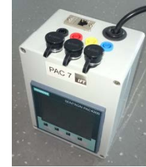
Multifunktions-Messgerät SENTRON PAC 3200/4200 für U, I, P, Q, S, \cos(\varphi)
