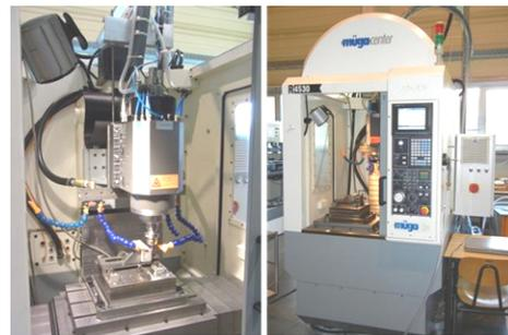
**Abbildung 25: Bearbeitungsmaschine mit Arbeitsraum und integrierter magnetgelagerter Spindel [22]**
