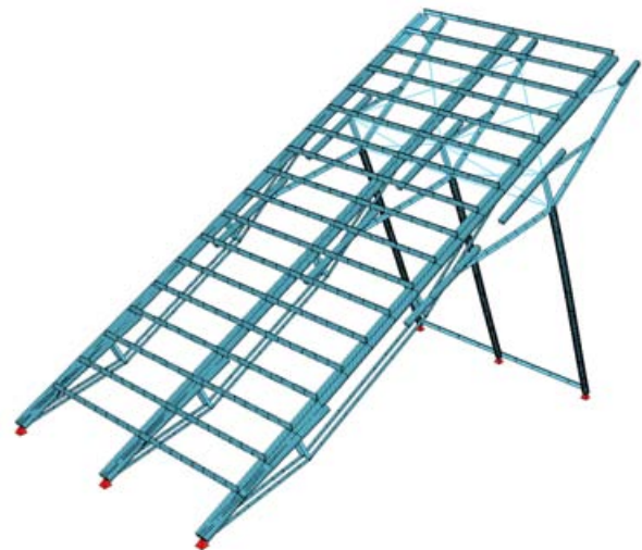
Knickfigur als Ergebnis der Bifurkationsanalyse unter Eigengewicht: Darstellungsfehler im Visualisierungsprogramm (Ursache leider ungeklärt, Modellangaben aber in dieser Hinsicht korrekt)
