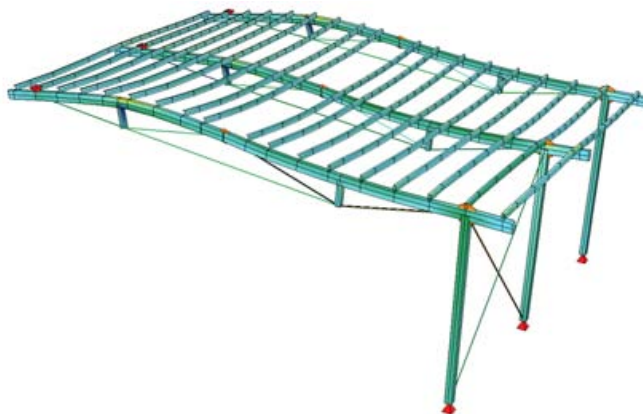
Verformung und Spannungen unter Eigengewicht
