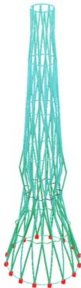
Verformung und Spannungen unter Eigengewicht
