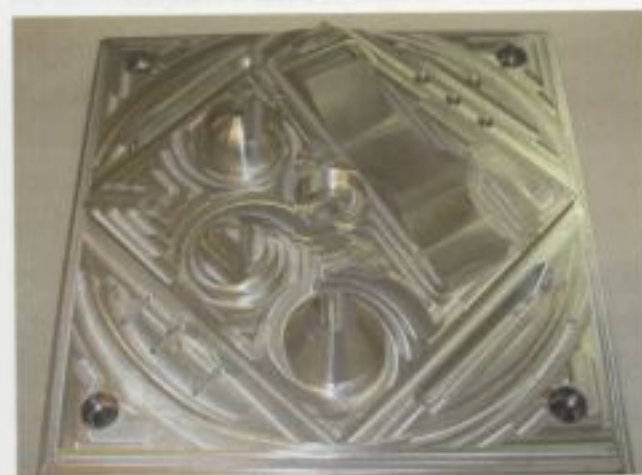
Fräsbahn unter VISI.
