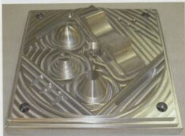
Fräsbahn unter GOelan.
