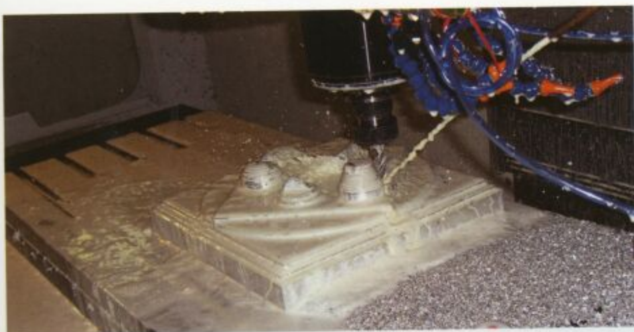
Das Werkstück während der Bearbeitung unter VISI.
