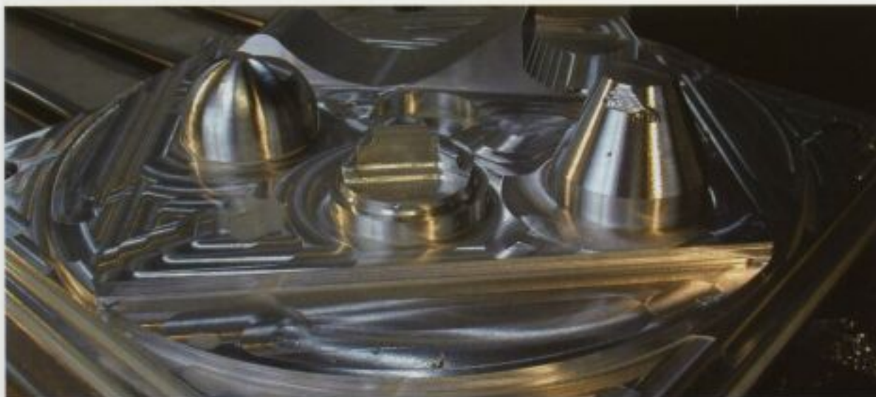
Folgen der Kollision mit einem Werkzeug nach der Bearbeitung unter VISI durch einen Bedienungsfehler bei der Programmierung.
