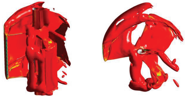
Abbildung 6: Darstellung der Interaktion zwischen der Wirbelstruktur eines Blattspitzenwirbels und einem nachlaufenden Rotorblatt als Isofläche der Wirbelstärke der Simulation 1
