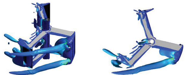
Abbildung 7: Darstellung der Interaktion zwischen der Wirbelstruktur eines Blattspitzenwirbels und einem nachlaufenden Rotorblatt als Isofläche der turbulenten kinetischen Energie der Simulation 2
