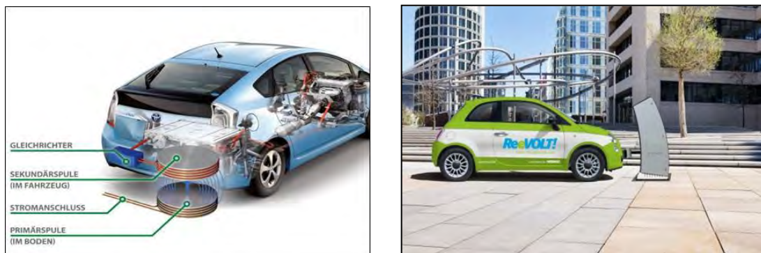
Abbildung 1-22: Ladeeinrichtungen für das induktive Laden am Fahrzeug und in der Fahrbahn
