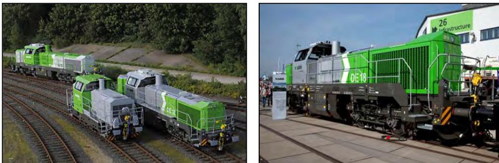
Abbildung 1-47: Vierachsige dieselektrische Lokomotiven DE 12/18 für die Güterbedienung von Vossloh
