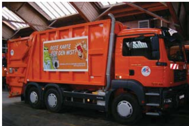
Abbildung 33: Variopress-Müllsammelfahrzeug für Metallverpackungen und Altpapier
