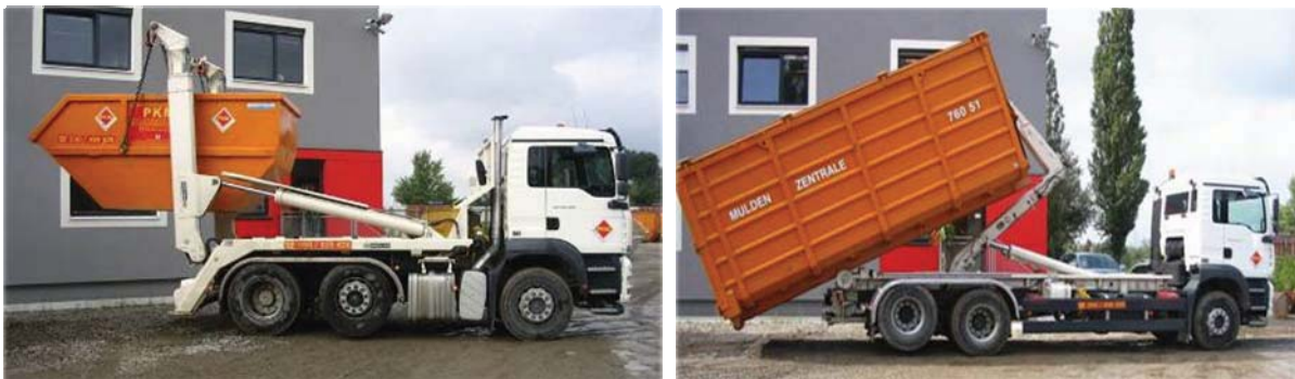
Abbildung 34: Absetzkipper mit 10 m 3 Mulde und Abrollkipper mit 40 m 3 Container
