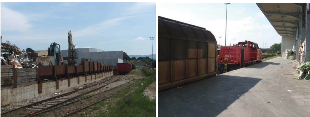
Abbildung 39: Altmittelverladung mit Greifer (links) und Altpapierballen-Verladerampe mit Witterungsschutz (rechts)
