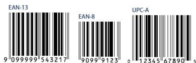
Abbildung 21: EAN Codes und UPC-A Codes - Kennzeichnung von standardisierten Endverbrauchereinheiten
