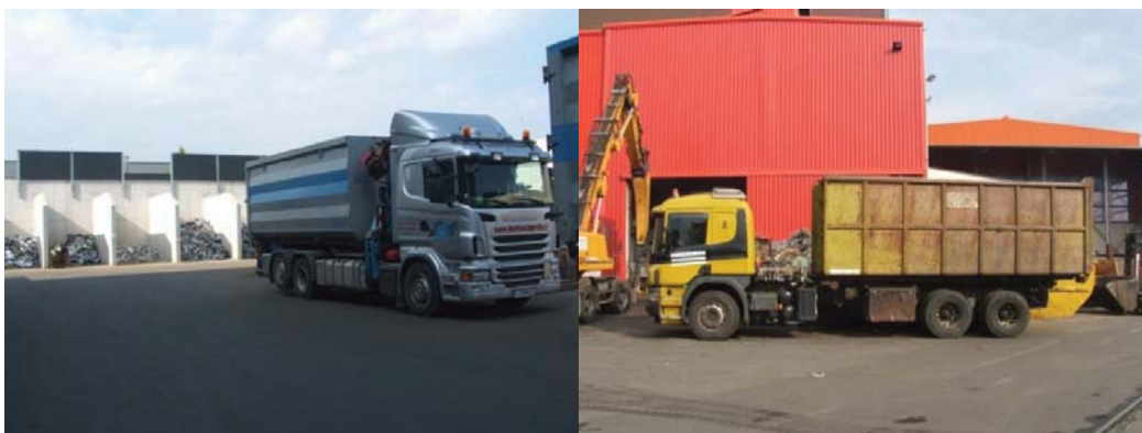
Abbildung 37: Abrollkipper mit Kran, im Hintergrund getrennte Lagerung der Wertstoffe und genügend Verkehrsfläche für die Schwerfahrzeuge (links); Entladung vor einer Kabelaufbereitungshalle (rechts)
