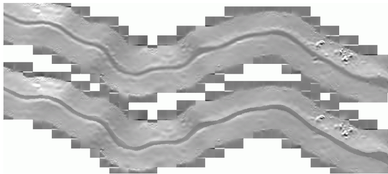
Abbildung 4: Geschummertes DGM ohne Modellierung der Geländekanten (oben) und mit Modellierung der Geländekanten (unten)
