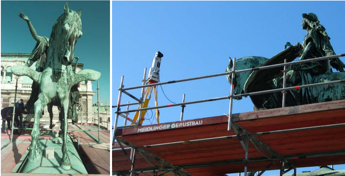
Abb. 1: Links: Die zu modellierende Pegasus-Statue auf der Wiener Staatsoper. Rechts: Der Laserscanner Riegl LMS-Z420i im Einsatz (Foto: Riegl LMS).
