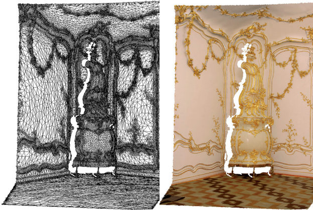
Links: Ausgedünnte, triangulierte Punktwolke (Ausschnitt) aus TLS-Daten des "Weißgoldzimmers", Schloss Schönbrunn. Rechts: 3D-Modell mit Textur
