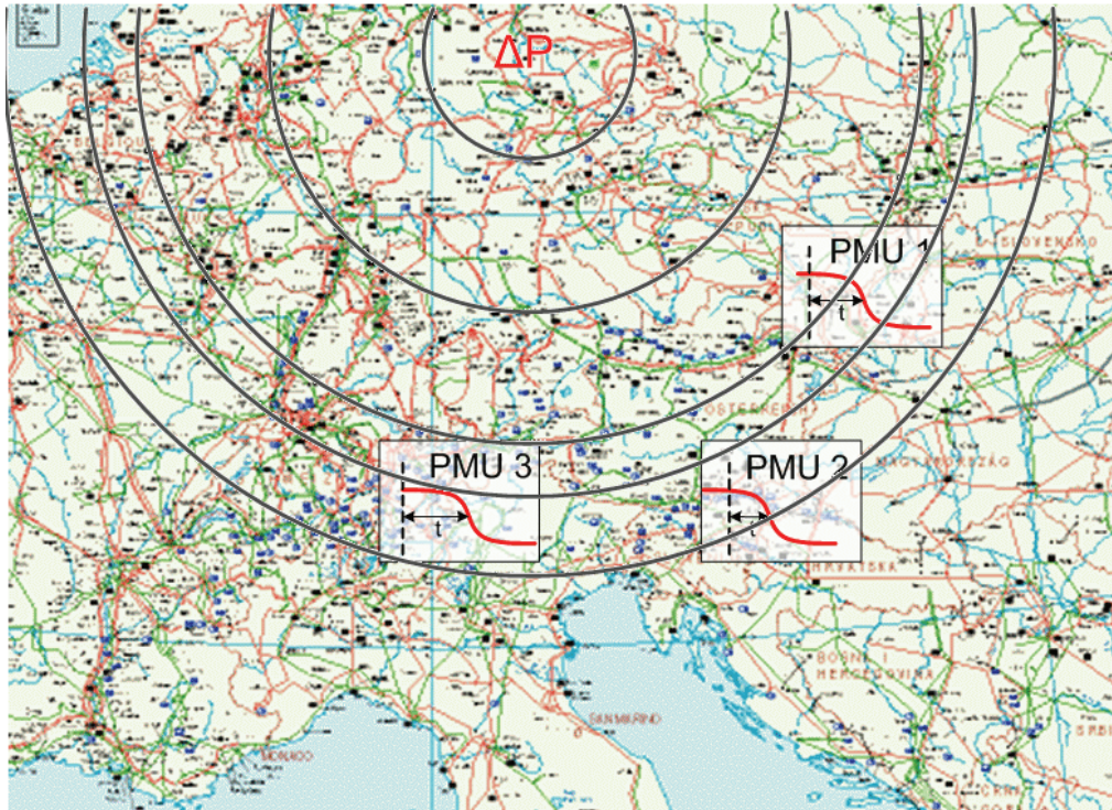
Abbildung 4.2: Prinzip der Wellenausbreitung mit Kurven gleicher Laufzeit
