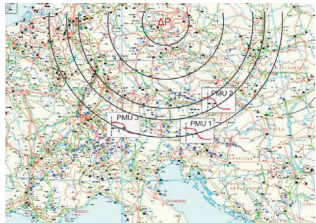
Bild 3 Prinzip der Wellenausbreitung mit Kurven gleicher Laufzeit [3]
