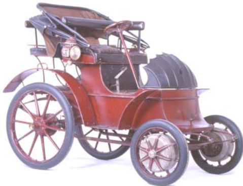
Bild 4 Lohner-Porsche mit elektrischen 2 kW-Radnabenmotoren an den Vorderrädern (Technisches Museum Wien).
