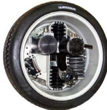
Bild 5 Michelin Aktive Wheel mit 30-kW-Radnabenmotor 2008.
