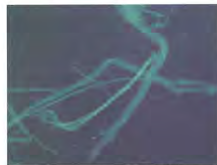
8 Papierprobe 4, UV-Aufnahme, 100fache Vergrößerung: schwache grüne Primär- oder Eigenfluoreszenz der Flachsfasern.
