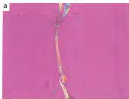
5 Papierprobe 4, Faserbestimmung nach Herzog, Faserinterferenzfarben in der Orthogonalstellung zwischen gekreuzten Polarisatoren und λ-Platte, 200fache Vergrößerung: (a) N-S-Stellung, orange Flachsfaser; (b) O-W-Stellung, indigoblaue Flachsfaser.
