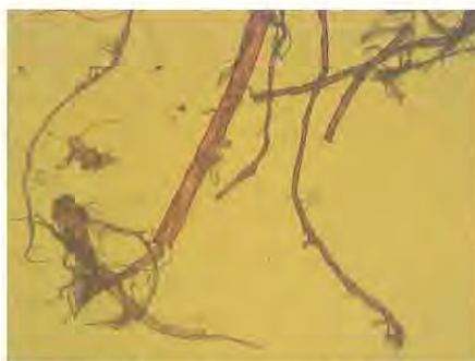
10 Papierprobe 4, Faseranfärbung (Flachs) mit Rhodamin 6G, Durchlicht, 100fache Vergrößerung.
