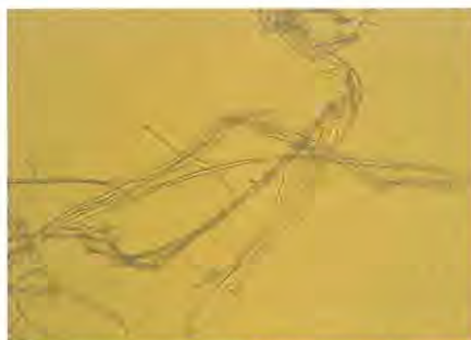
2 Papierprobe 4, Flachsfasern im Durchlicht, 100fache Vergrößerung.
