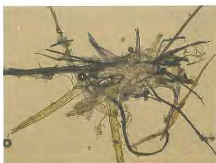
6 Papierprobe 7, Fasermischung angefärbt mit Chlorzinkjod nach Herzberg, 100fache Vergrößerung: Holzschliff gelb, Zellstoff blau.
