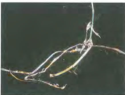
4 Papierprobe 4 mit gekreuzten Polarisatoren, 100fache Vergrößerung.
