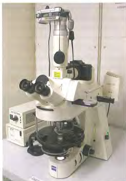
1 Lichtmikroskop Axioplan 2 (Carl Zeiss). Akademie der bildenden Künste Wien, Institut für Konservierung und Restaurierung.
