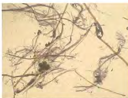
7 Papierprobe 4, Fasern angefärbt mit Chlorzinkjod nach Herzberg, 100fache Vergrößerung: Hadernfasern hellrot bis weinrot.
