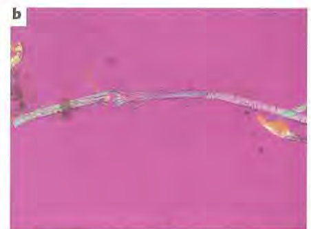
5 Papierprobe 4, Faserbestimmung nach Herzog, Faserinterferenzfarben in der Orthogonalstellung zwischen gekreuzten Polarisatoren und λ-Platte, 200fache Vergrößerung: (a) N-S-Stellung, orange Flachsfaser; (b) O-W-Stellung, indigoblaue Flachsfaser.
