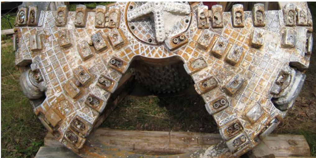
Abbildung 1 Unterschiedlicher Verschleiß über den Schneidradquerschnitt [Quelle: Martak.geo]
