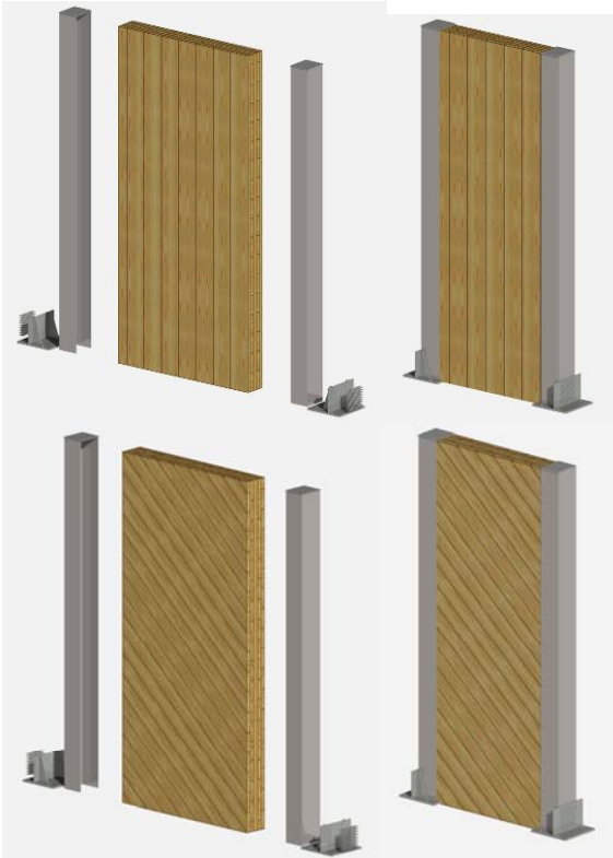
Abbildung 12: Verankerungssystem Figure 12: Anchorage system
