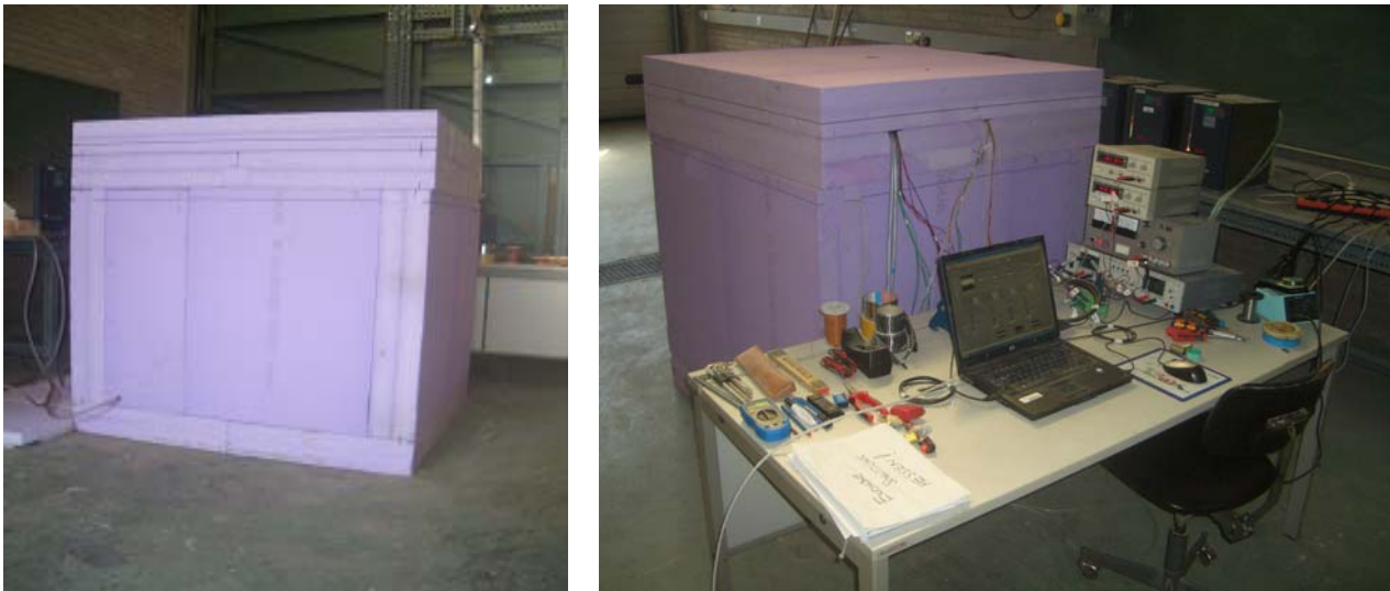
Abbildung 4: Betriebsbereite Einplattenapparatur mit Wärmedämmung, Kryostaten, Mess- und Regelungstechnik und Datenerfassung
