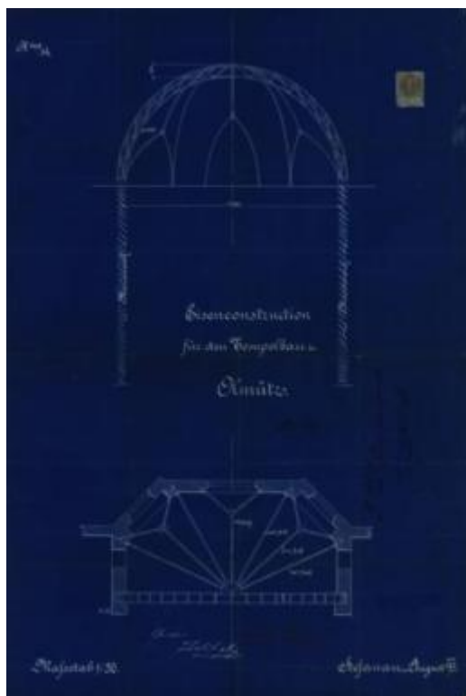
Abb. 32 Eisenkonstruktion über dem Chor
