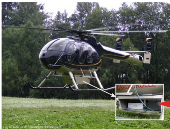
Laserscanner: Messrate bis zu 400.000 Messungen / Sekunde
