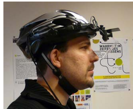
Abbildung 2. Der mobile Eye Tracker SMI iView X HED
