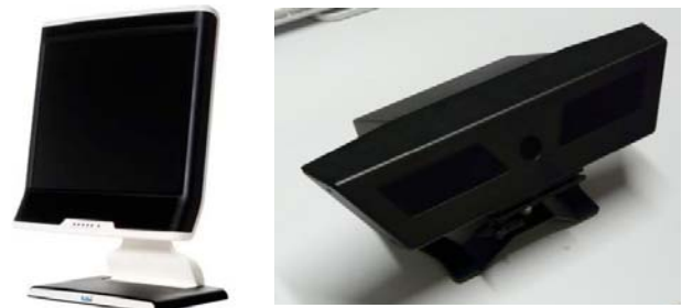
Abbildung 1. Stationäre Eye Tracker (links Tobii T120, rechts Tobii X50)
