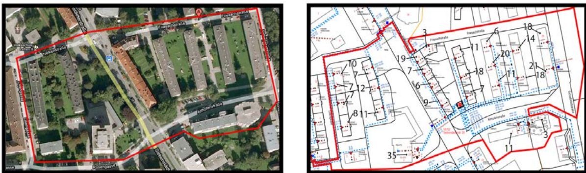
Abbildung 1 – Netzabschnitt 0752: Satellitenbild (Quelle: Google Maps) und schematische Darstellung (Quelle: Salzburg Netz GmbH, mit Anzahl der Personen je Wohngebäude)
