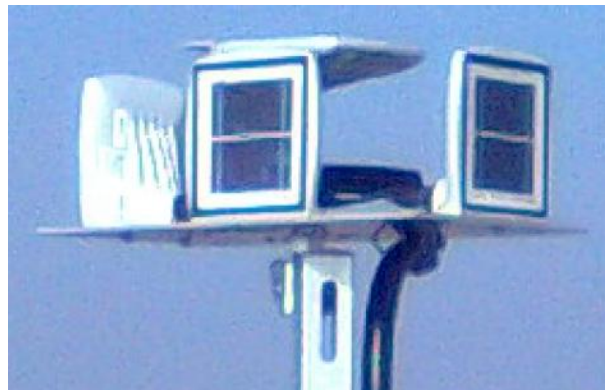
Abbildung 2: Richtungsabhängige Einstrahlungsmessung mit Sensor nach Osten, Süden, Westen sowie einen horizontalen Sensor [2]
