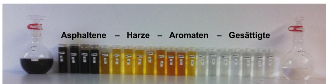
Abbildung 2: Darstellung der Bitumenauftrennung nach Polarität der Bestandteile [HANDLE, 2013]
