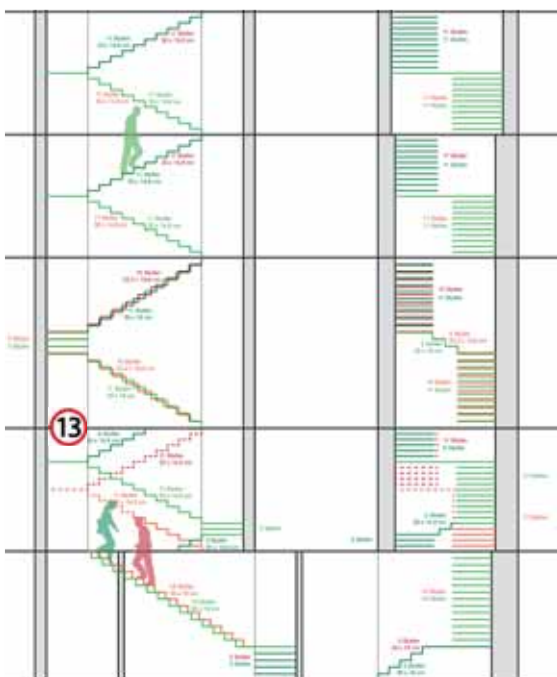
Abb.4.2.23 Das Einfügen von Stufen schafft genügend Abstand zur Kellertreppe (13), lässt das letzte Teilstück jedoch unfertig wirken (1:200)
