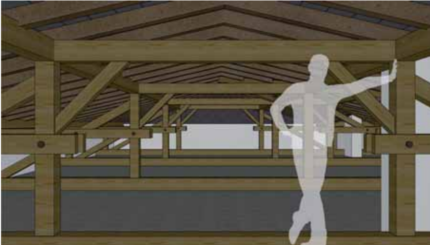
Abb.5.1.13 Das Innere der Hauptdachkonstruktion
