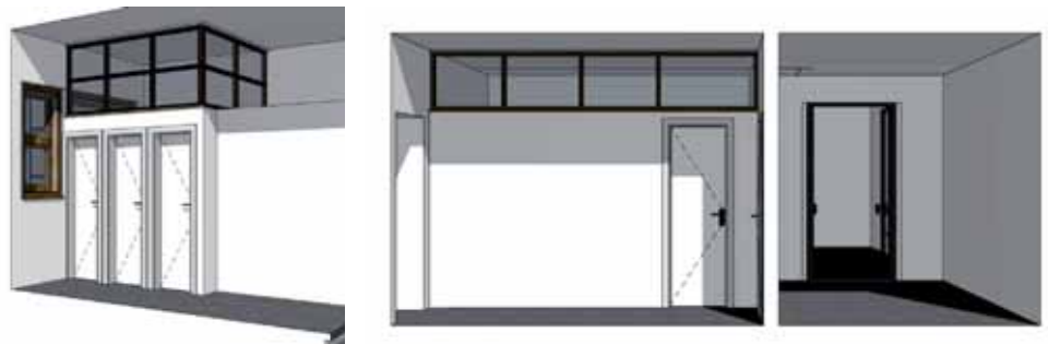
Abb.5.2.18, 19 Oberlichten für die WCs im ersten Obergeschoß und dem Erdgeschoß
