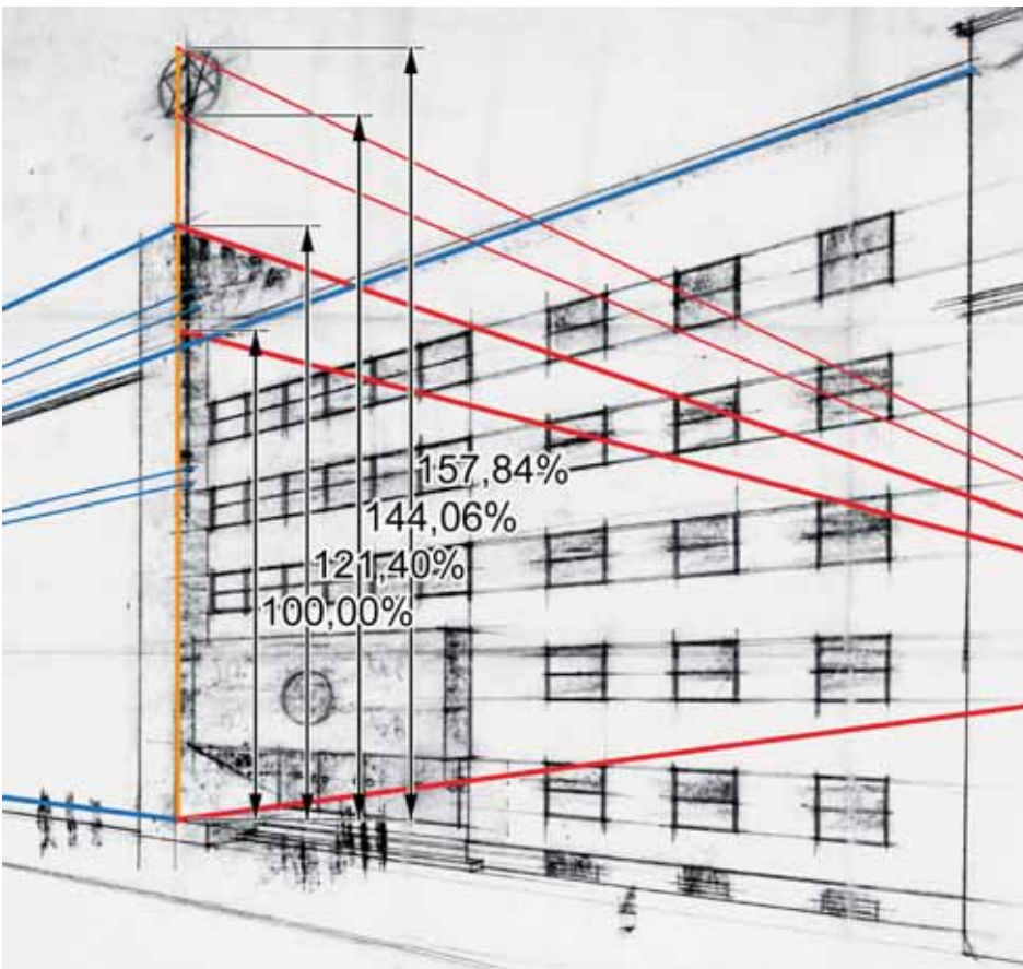
Abb.4.4.6 Abmessung des Pfeilers in der Außenperspektive: 100% entspricht der Höhe von Erdgeschoß zu Traufe. Die blauen Doppellinien markieren die Befestigung des Stabs für den Davidstern.
