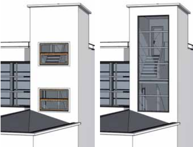
Abb.4.4.36, 37 Vergleich: Belichtung der Terrassentreppe
