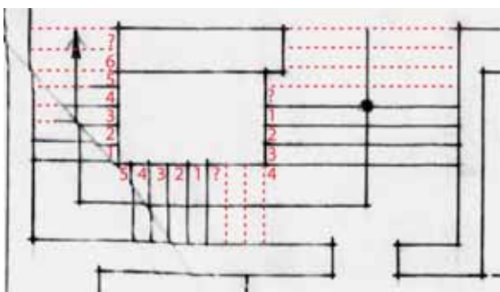
Abb.4.2.6 Mehr Stufen für die Kellertreppe möglich
