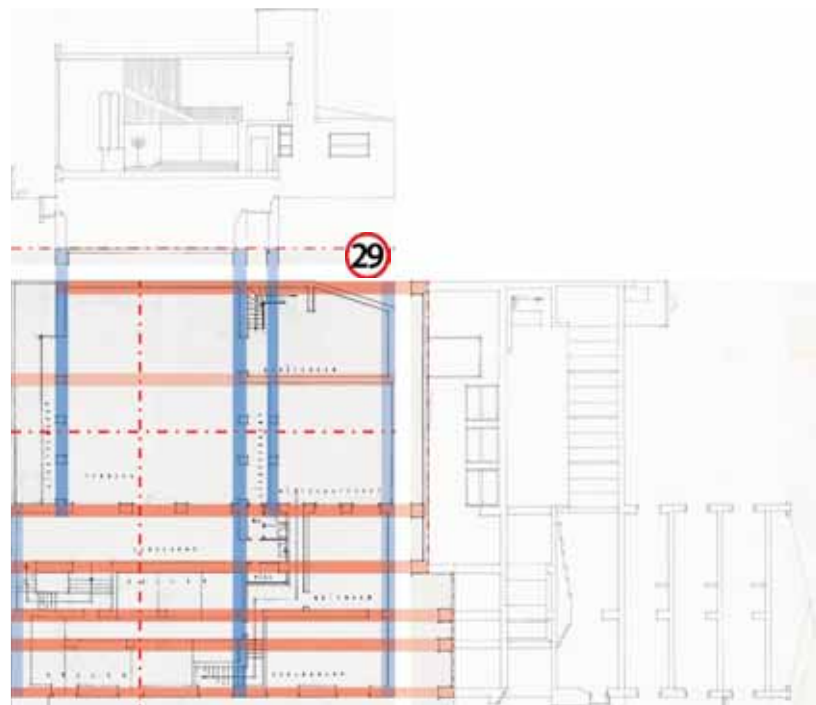
Abb.4.1.21 Fundamentierung aus den Schnitten
