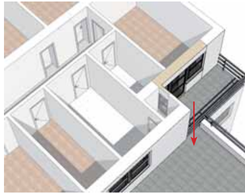
Abb.4.4.41 Balkon und Terrasse befinden sich auf gleicher Höhe.
