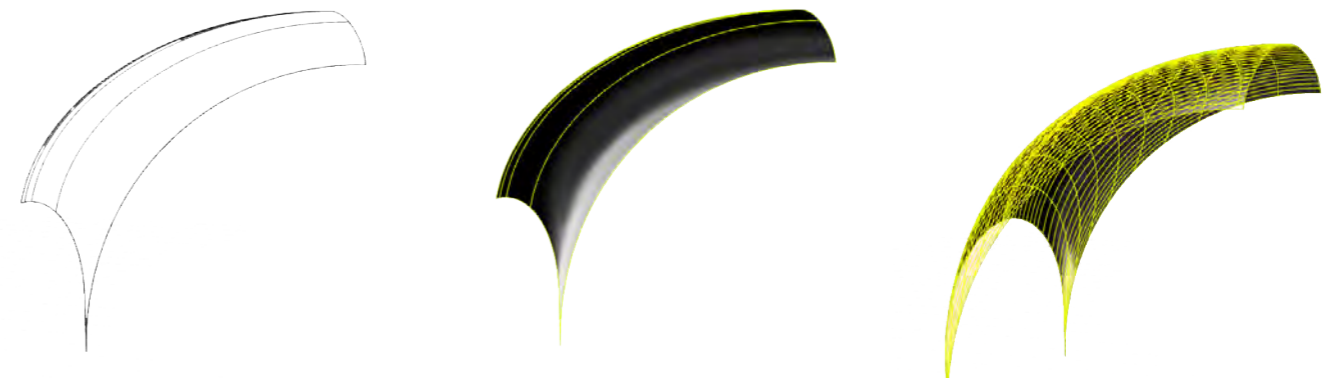
Abb. 127: Gewölbemodellierung mittels Rhino-Flächenwerkzeug Schritt 1,2,3
