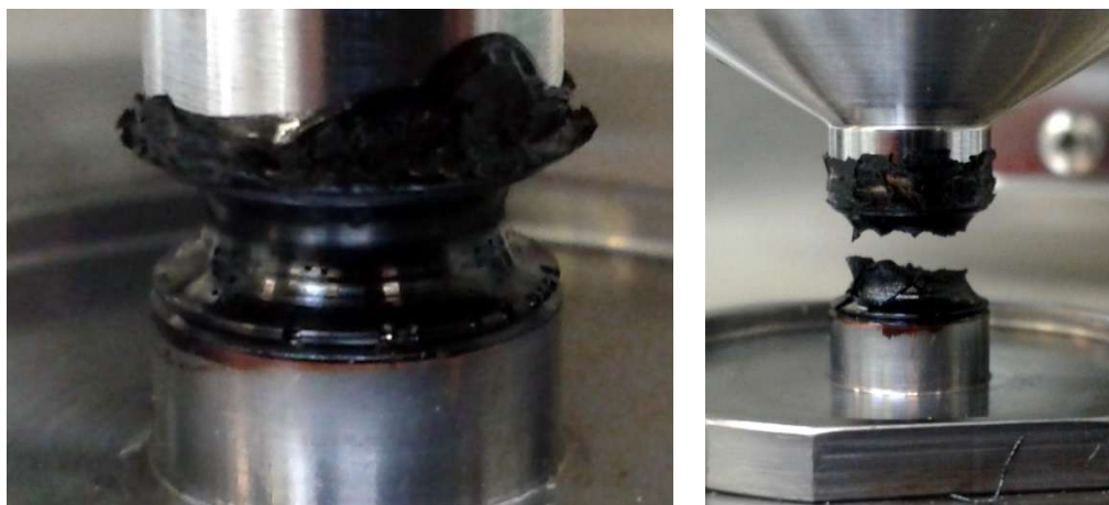
Abbildung 4: Edelstahl-Positivform, Gießereiter Aufbau im DSR, Silikonform
