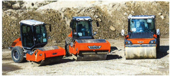
Abb. 5: Die drei Testwalzen zur Erprobung des FDVK-Systems für Oszillationswalzen
