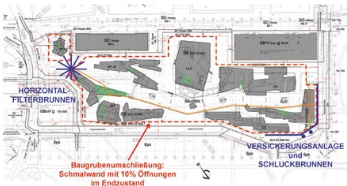
Abb. 1 Neubau Campus WU Wien – Thermische Grundwassernutzungsanlage, Grundwasserentnahme (Horizontalfilterbrunnen) und Rückgabe (Versickerungsanlage und Schluckbrunnen).
