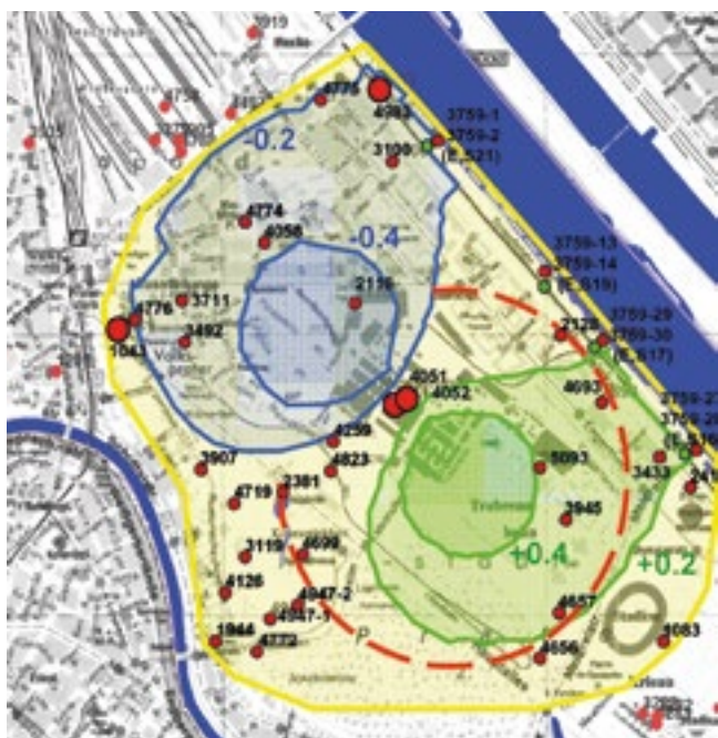
Abb. 3 Hydraulische (blau: Absenkung; grün: Aufspiegelung) und thermische (rot strichliert) Einflussbereiche sowie umliegende (rote Punkte) und betroffene (große rote Punkte) Wasserrechte (innerhalb des möglichen Einflussbereiches (gelber Bereich)).
