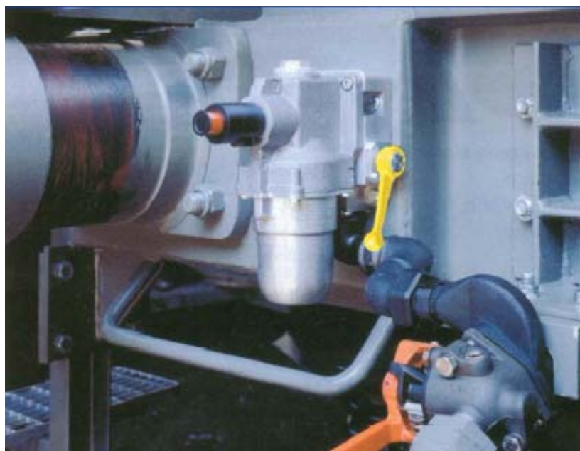
Abb.5. Beispiel für einen fahrzeugseitigen Entgleisungsdetektor
