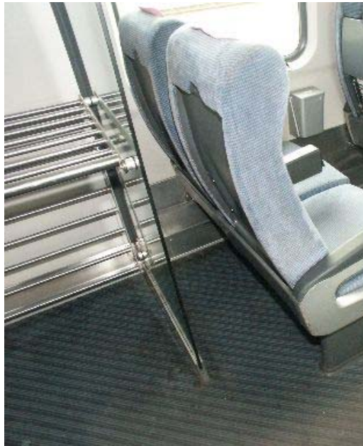
Abbildung 21: Der Platz zwischen Seitensteher und Sitz kann nicht genutzt werden, daher scheint eine andersartige Lastabtragung und teilweise Freihaltung der Bodenfläche sinnvoll.
