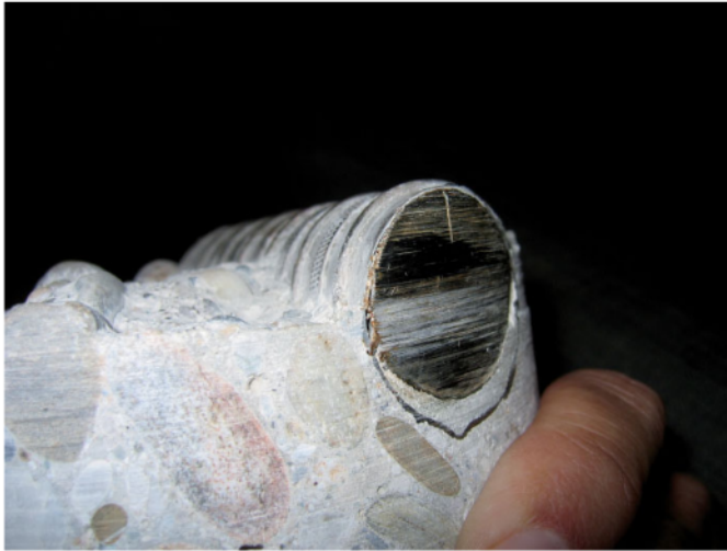
Bild 4. Bohrern mit Spannstahl, Hüllrohr und Verpressmörtel
