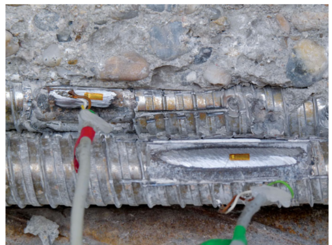
Bild 8. Freigelegte Spannglieder inkl. applizierter Dehnmessstreifen Fig. 8. Open tendons with applied strain gauges
