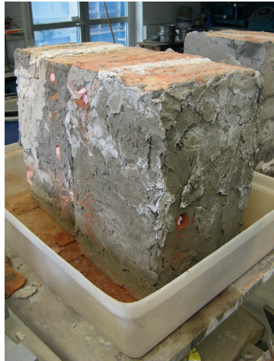
Abb. 13: Wassersaugversuch an Kleinpfeilern, im Vordergrund der Vergleichspfeiler ohne Injektion Fig. 13: Water sinking test on masonry
