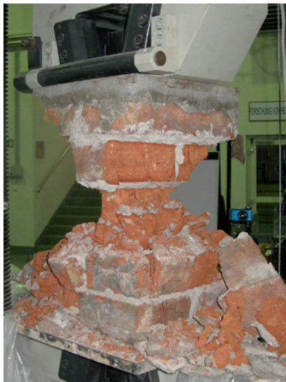
Abb. 2: Im Druckversuche geprüfter Mauerwerkskleinfleiler Fig. 2: Masonry after the compression test
