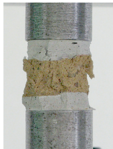
Abb. 1: Bruchform beim Stempeldruckversuch Fig. 1: Fracture after compression test
