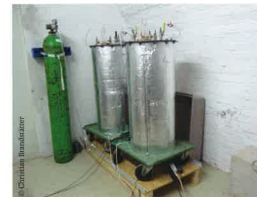
In Deponiereaktoren können Emissionen aus Hausmülldeponien im Labor simuliert werden.
