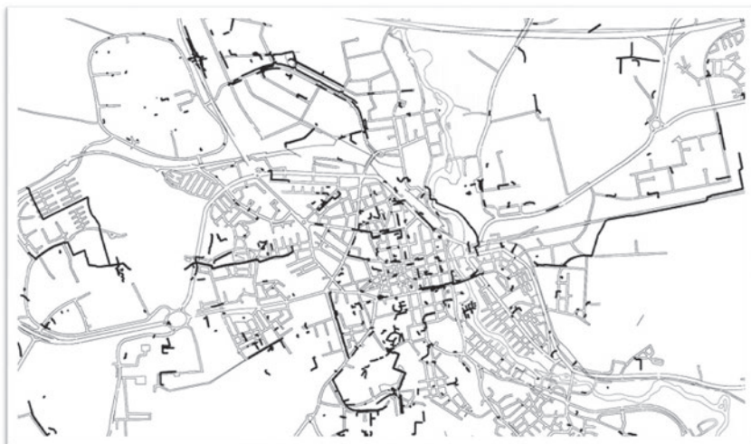
Abb. 2: Stillgelegte Stromleitungen im Stadtzentrum von Linköping (Schweden) als Gegenstand einer integrierten Instandhaltungs- und Rückbaustrategie auf Unternehmensebene. Fig. 2: Disconnected power supply cables in the center of Linköping (Sweden) as subject of integrated maintenance and recovery strategy on operational level.
