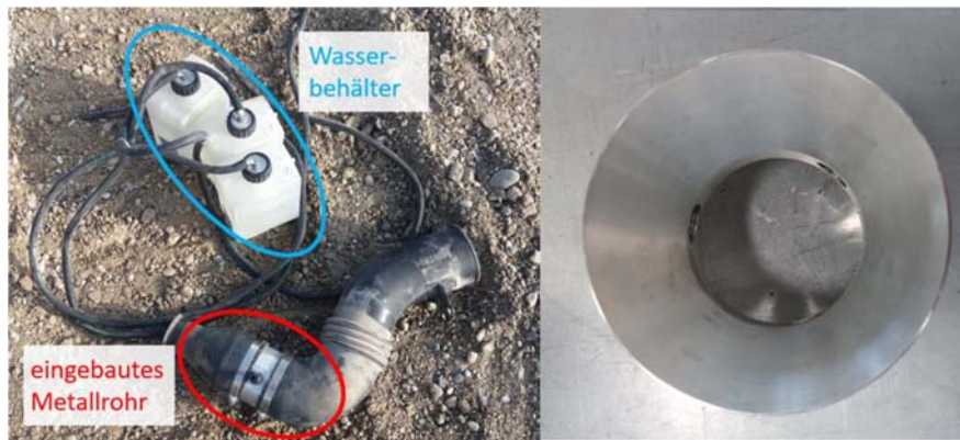
Abbildung I-1: Bestandteile der DROP-NO x -Applikation (li.), Metallrohr mit Querschnittsverjüngung (re.)
