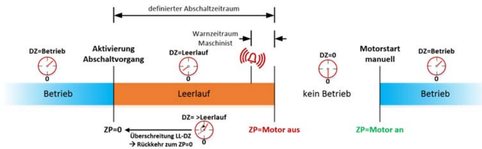
Abbildung I-2 15 : Schema zur Funktionsweise einer automatischen Motorabschaltung
