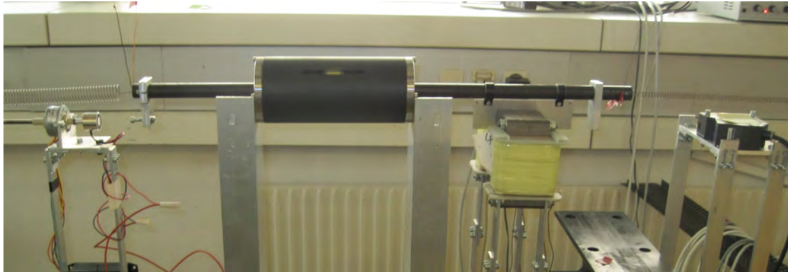
Abbildung 3.3: Kleine Masse im Zylinder zur Parametererregung mit Wirbelstrombremse, Laser-messeinrichtung und Schrittmotor zur Auslenkung
