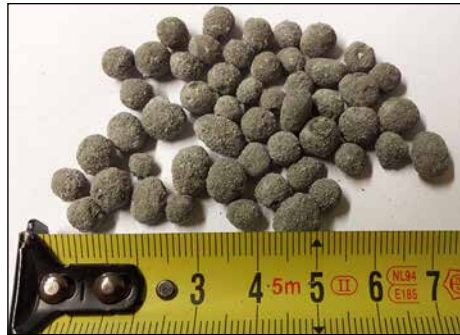
Bild 2: Erzeugte Pellets mit Maßstab; Zielgröße etwa 8 mm
