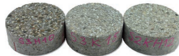
Abbildung 6: Betonoberflächen nach Oberflächenvorbehandlung (v.l.n.r. HöDW, K, K+HDW)
