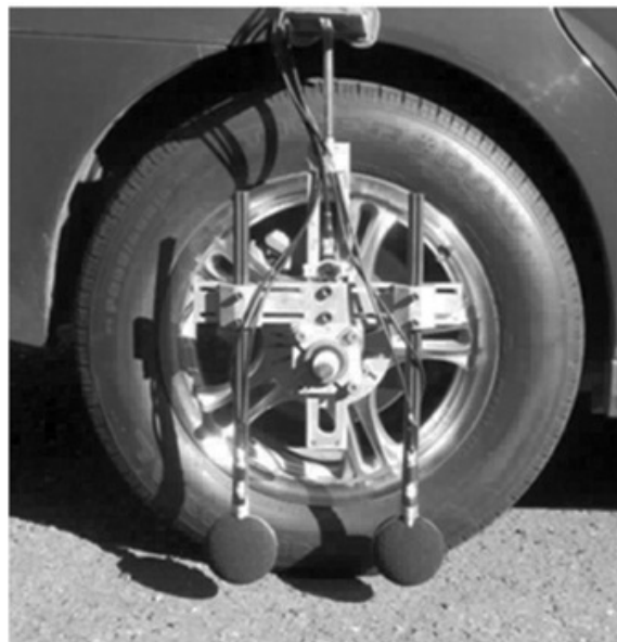
Abbildung 3.7: Dual-Intensitätssonden in vertikaler OBSI-Anordnung. [26]
