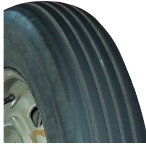
Abbildung 5.28: Reifenprofil des Piarc-Reifens.
