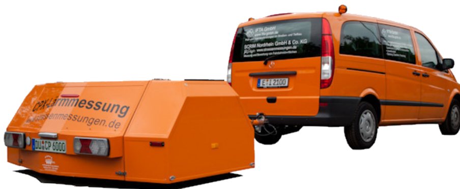
Abbildung 3.1: Messanhänger zur Ermittlung des Reifen-Fahrbahngeräusches nach CPX. [24]
