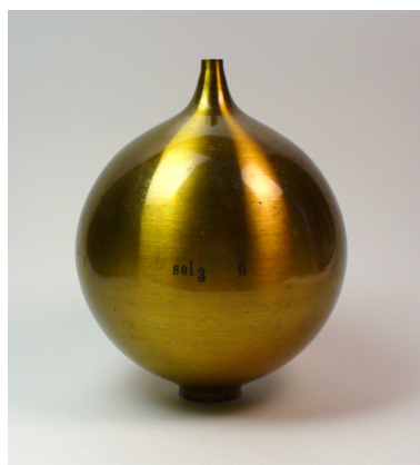
Abbildung 2.21: Helmholtz-Resonator aus Messing, um 1900. [22]
