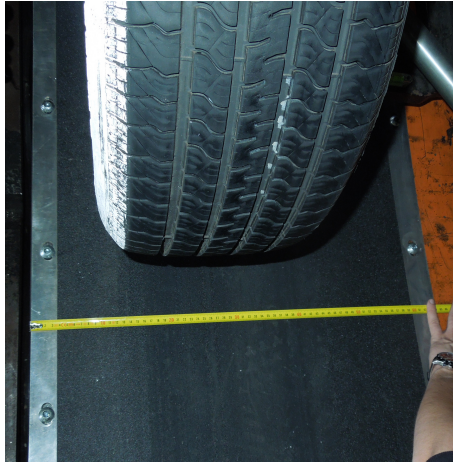
Abbildung 4.2: Safety-Walk - Fahrbahnbelag im Prüfstand Fahrzeug-Fahrbahn der BAST
