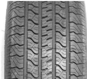
Abbildung 5.26: Reifenprofil des SRTT-Reifens. [29]
