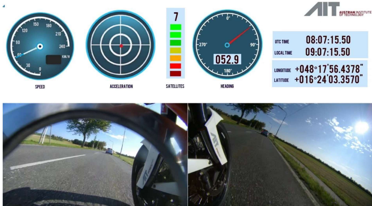
Bild 3: Screenshot des Video-Auswerteprogramms mit gleichzeitiger Darstellung der beiden Kamera-Aufnahmen. Weitere Funktionen des Tools erlauben auch die gleichzeitige Ausgabe von Messgrößen.
